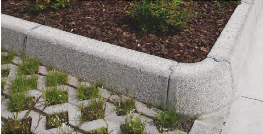
Cordolo con una struttura massiccia che unita al profilo a incastro maschio/femmina, garantisce una stabilità eccezionale nel caso di comuni sollecitazioni orizzontali. Il pezzo speciale curvo e l'elemento a bocca di lupo, ottimizzato per facilitare il drenaggio e la pulizia, completano la modularità del sistema.
